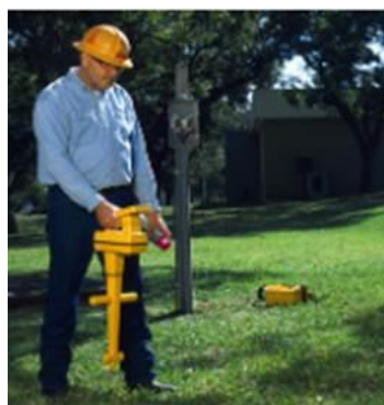
Rys. 40. Lokalizowanie i pomiar głębokości znaczników elektromagnetycznych
