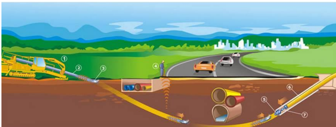
Rys. 29. Wykonywanie otworów pod kanalizację kablową metodą przewiertu
